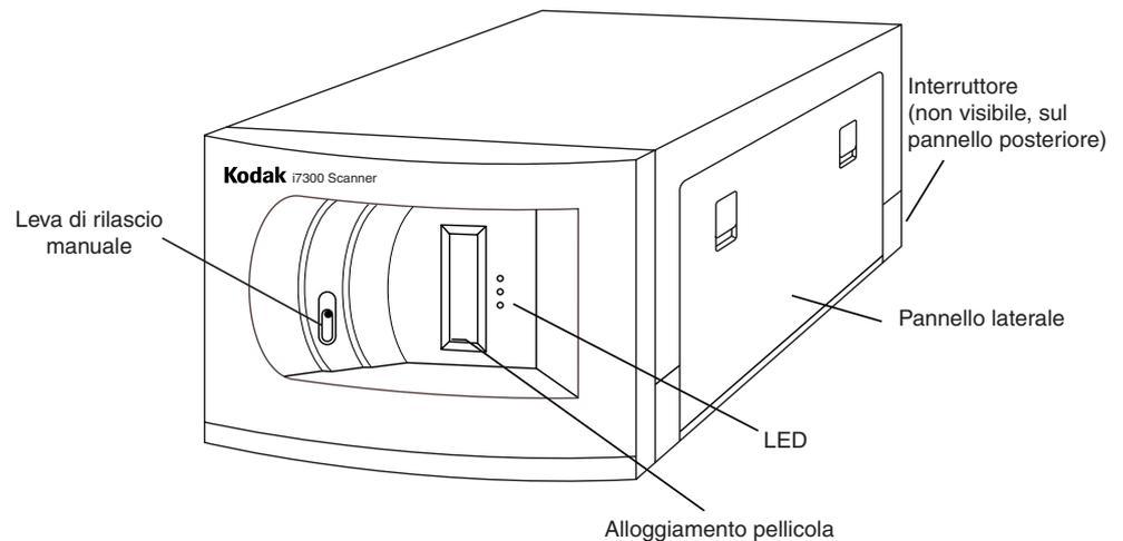
La leva di rilascio manuale consente di estrarre manualmente il caricatore inserendo nella fessura un oggetto sottile, come una matita. Utilizzare questa leva se si verifica un inceppamento o una rottura della pellicola, oppure per rilasciare il caricatore di pellicola in caso di assenza di alimentazione.
