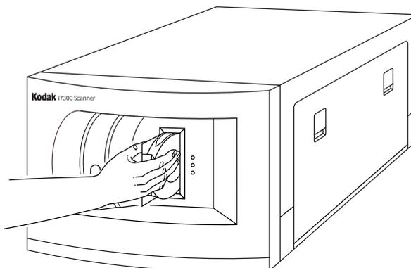
2. Inserire il caricatore nell'apposito alloggiamento fino all'arresto. Verificare che il caricatore sia inserito saldamente lungo il lato inferiore.
