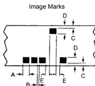
NOTA: le dimensioni minime del blip grande devono essere superiori di almeno 0,97 mm (0,038 pollici) rispetto alle dimensioni massime del blip medio. Le dimensioni minime del blip medio devono essere superiori di almeno 0,89 mm (0,035 pollici) rispetto alle dimensioni massime del blip piccolo.
